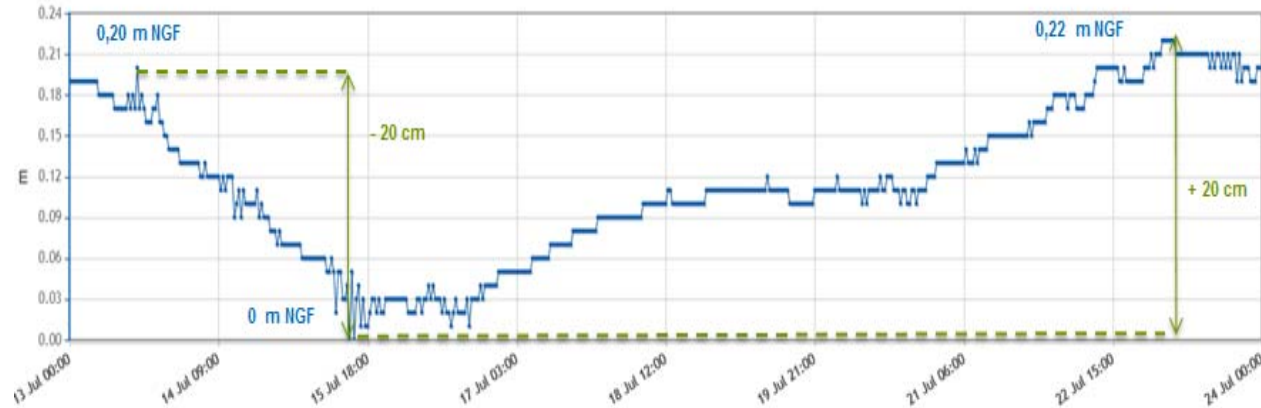
Hauteurs d'eau mesurées à « l'échelle 8 » (sonde permanente) dans l'étang du Médard sur la période de vidange
