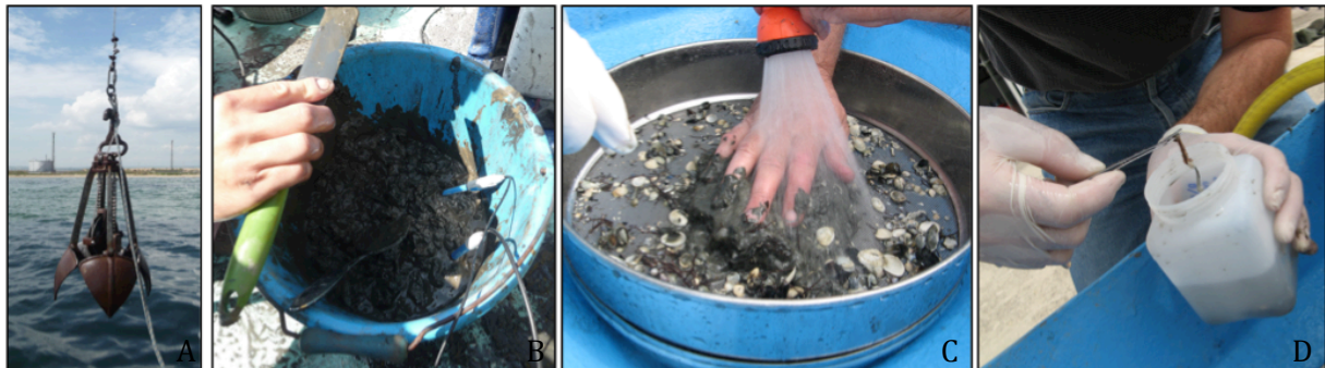
Figure 14 : Photographies de la benne orange peel (A) utilisée pour le prélèvement de sédiment de surface (B) et d'organismes après tamisage (C et D).
