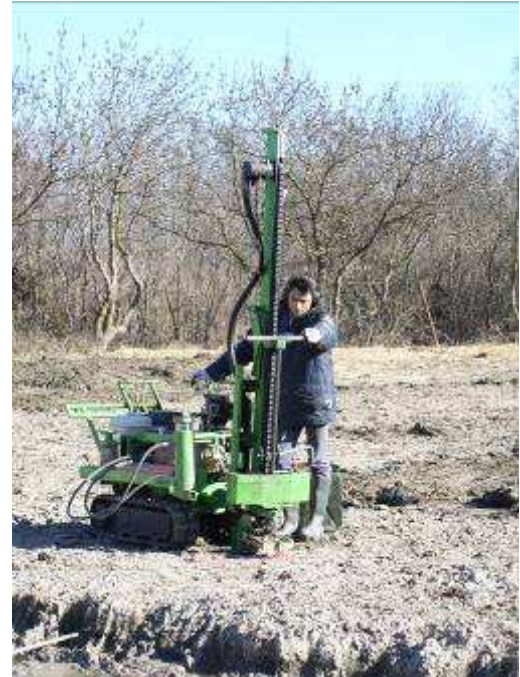
Etudes géotechniques : analyse du sol (visuelles et chimiques) et tests au pénétromètre
