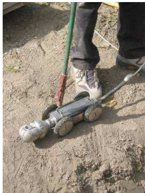
Après contrôle à l'étanchéité (en haut à gauche) et passage de caméra (ci-dessus et en bas à droite), le puits n'est pas étanche (ce problème sera réglé par l'ajout de bridages supplémentaires) et présente des « flashes » (discontinuités de pentes) problématiques
