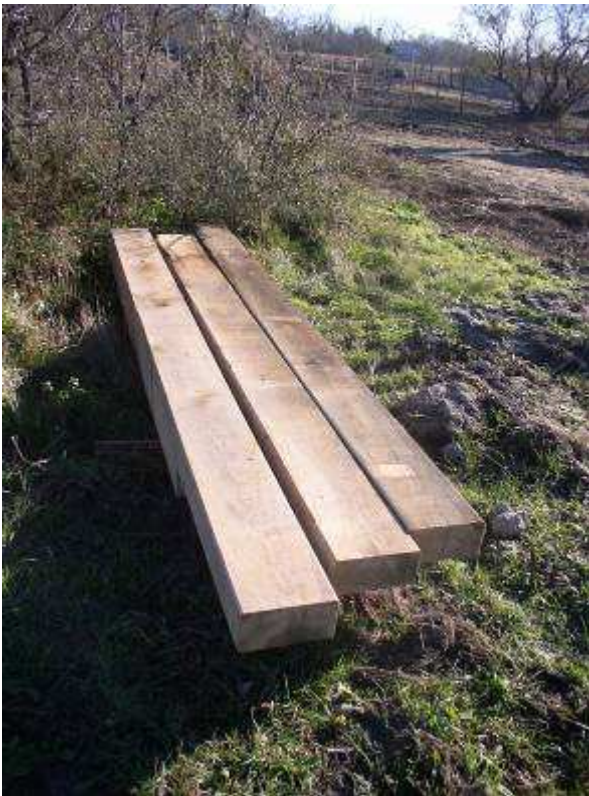
Poteaux de chêne de 25cm par 25 et servant de fondation au hangar (à gauche). Vue des fondations achevées (à droite). La découpe dans les poteaux en chêne accueillera quelques mois plus tard, une fois les fondations stabilisées, l'ossature en douglas. En cas de pourrissement prématuré d'un poteau, celui-ci pourra être changé par simple étayage, sans avoir à démonter l'ensemble du hangar.
