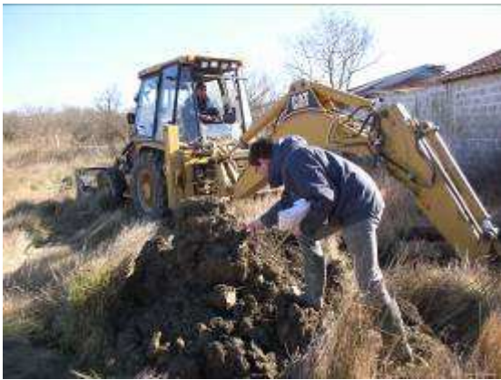
Etudes géotechniques : analyse du sol (visuelles et chimiques) et tests au pénétromètre
