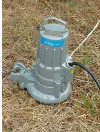
Figure 187 : Nouvelle pompe de refoulement installée
