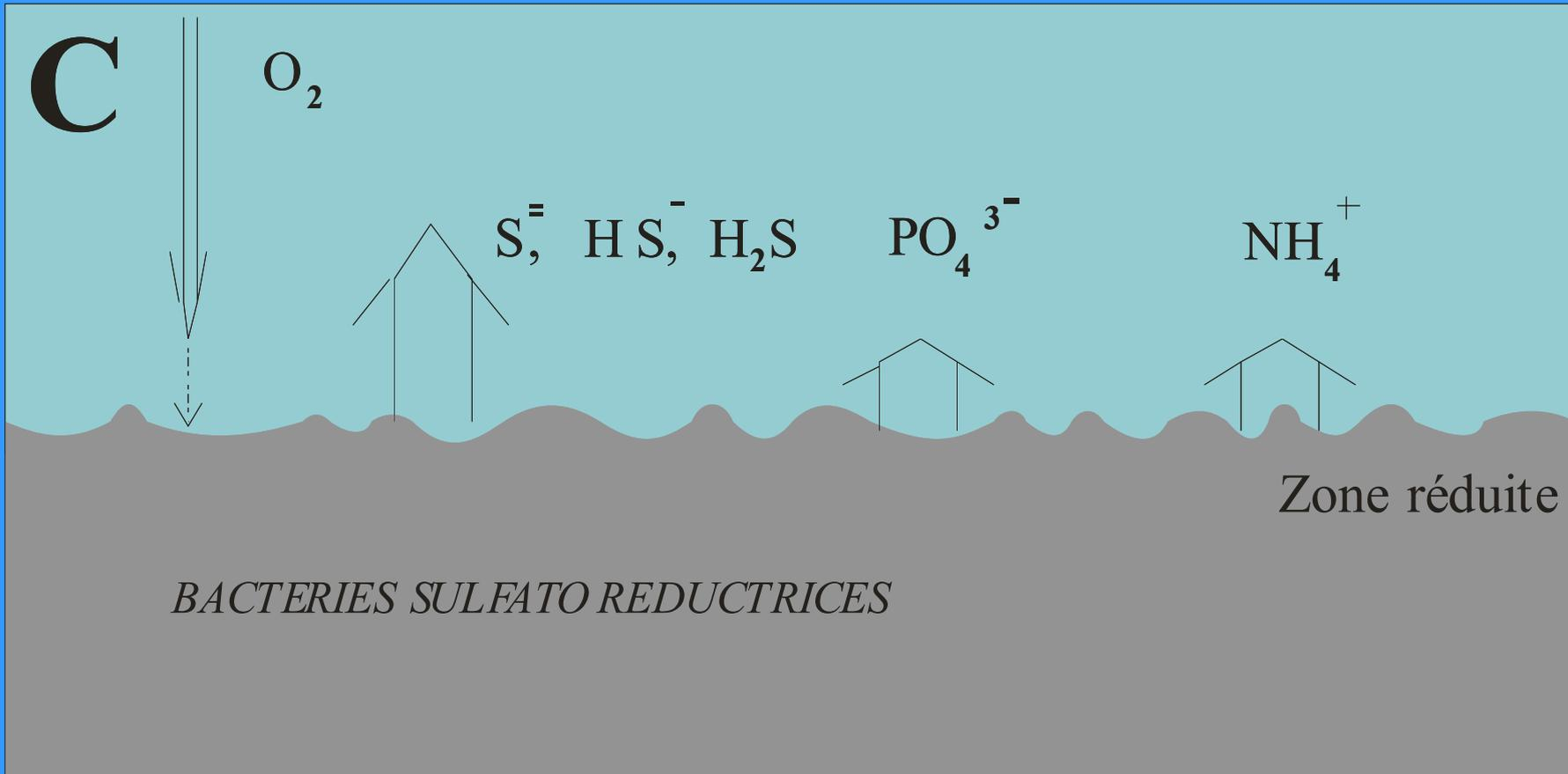
L'interface eau-sédiment dans un environnement avec épuisement de l'oxygène à l'interface eau-sédiment
