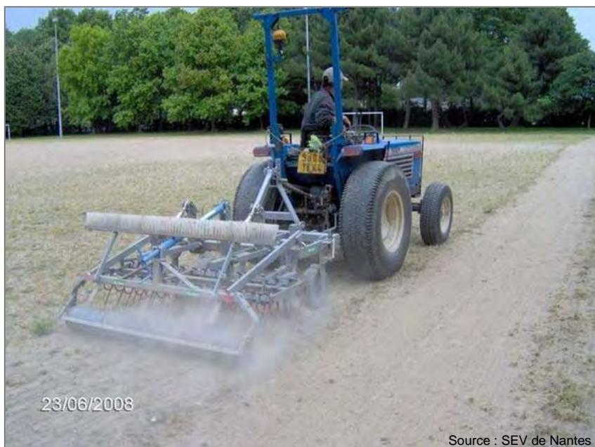
**Photographie 8** : Appareil de désherbage mécanique tracté.
