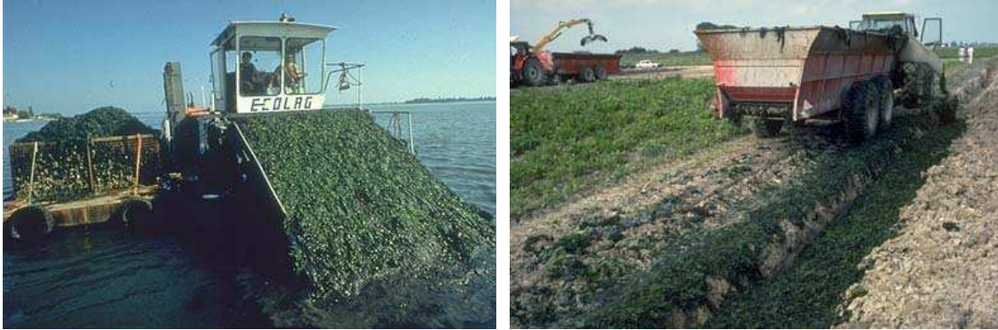
Ramassage des macroalgues dans la lagune et épandage agricole (source : Consorzio Venezia Nuova, 2008)
