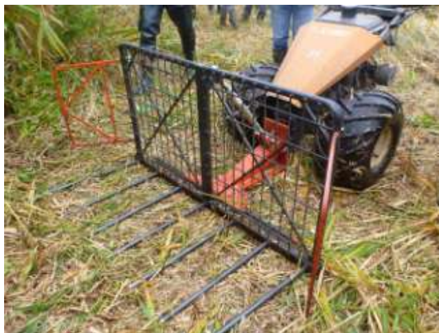
Un modèle de faucheuse-ramasseuse développé par le Conservatoire des Sites Lorrains. Photo F. Muller
