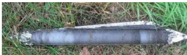
Exemple de sondage au carottier à tourbe (photo BURGEAP)
