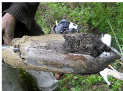
Exemple de sondage à la tarière (photo BURGEAP)
