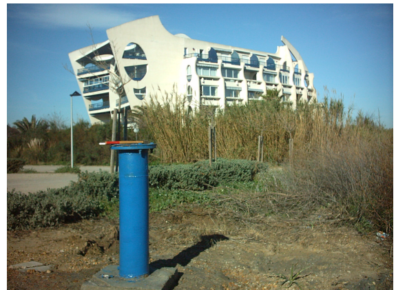
Piézomètre sur le site de la Grande Motte
