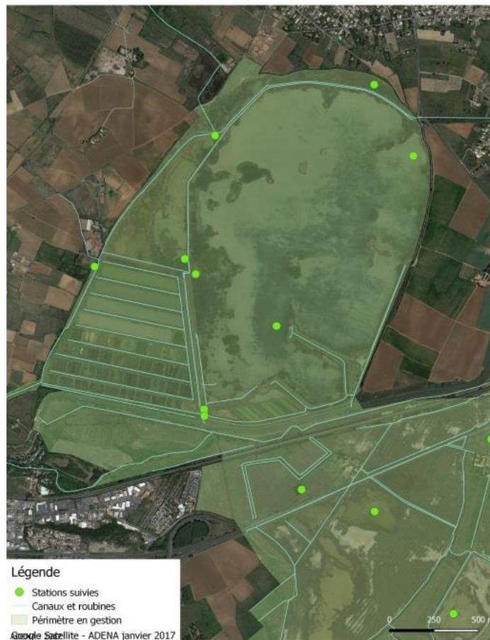
Sur chacune de ces stations, un piézomètre et une échelle sont installés afin de suivre l'évolution de la hauteur d'eau en surface et en profondeur. Un prélèvement d'eau est réalisé toutes les 2 semaines en surface et profondeur. Des mesures de salinité, conductivité, pH, température, turbidité, oxygène dissout sont effectuées.
