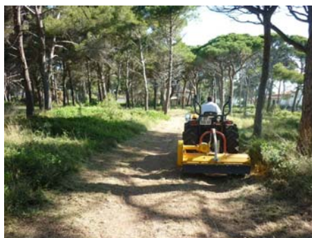
Réouverture des pistes par girobroyage (commune d'Hyères), juin 2012
