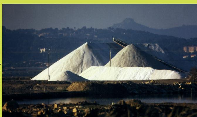
Quand le saunier obtient l'épaisseur de sel voulue sur les tables salantes, le sel est alors récolté et mis en **camelles** (*tas de sel*) avant d'être conditionné et expédié.
